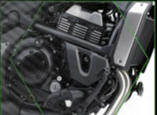
Mesin yang kompak disetting untuk menghasilkan torque maksimum pada putaran bawah dan menengah, menghasilkan karakter mesin yang mudah dikendarai dan akselerasi yang baik.
