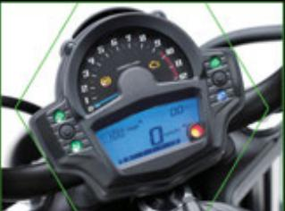
Instrument yang kompak dan didesain bertumpuk sehingga menyatu dengan desain keseluruhan motor dan mudah dilihat. Tachometer analog dan layar LCD multi fungsi menggunakan LED warna biru yang mudah dilihat waktu malam.
